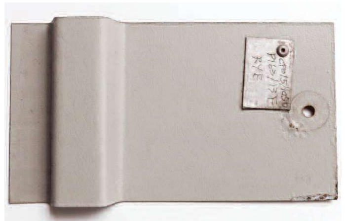
圖 18. 具備 Galvalloy® 金屬鍍層的 Colorcoat HPS200® – 在英國的 Rye 海洋耐候測試場，經過 18 年的暴曬之後的狀況
