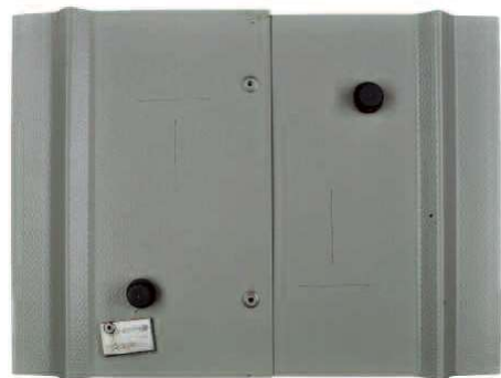
圖 13. Colorcoat HPS200 Ultra®測試樣品(在法國布列斯特(Brest) 暴曬 2年以上之後的狀況)
