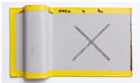
圖 22. 1,000 小時水浸泡測試後的板片狀態
