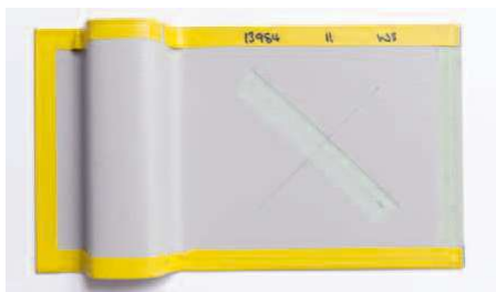
圖 22. 1,000 小時水浸泡測試後的板片狀態
