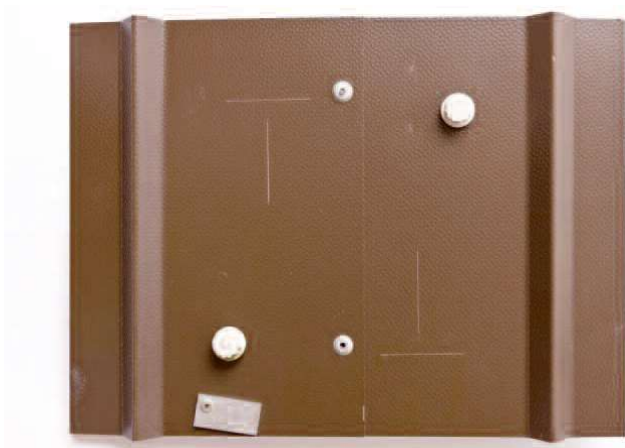
圖 16. 具備 Galvalloy® 金屬鍍層的 Colorcoat HPS200® – 在英國的 Rye 經過 6 年的暴曬之後的狀況
