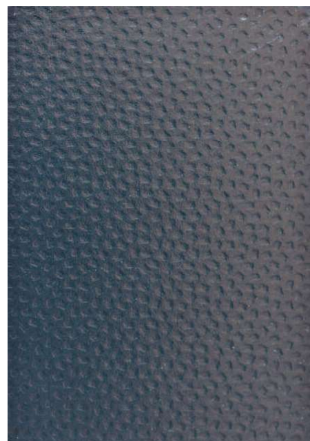
圖 29. Heritage 綠色的一般皮紋鋼板和 Colorcoat HPS200 Ultra®，經過 2,000 個小時的 UVB 測試後照片比對
