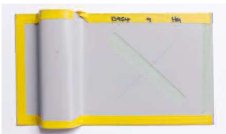
圖 21. 1,000 小時濕度測試後的板片狀態
