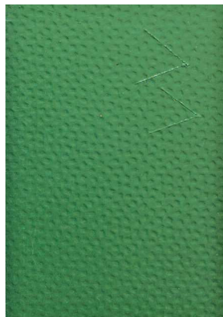
圖 29. Heritage 綠色的一般皮紋鋼板和 Colorcoat HPS200 Ultra®，經過 2,000 個小時的 UVB 測試後照片比對
