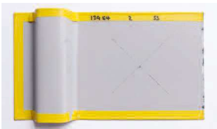
圖 21. 1,000 小時濕度測試後的板片狀態
