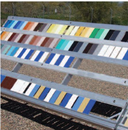
Colorcoat Prisma® 卓越的抗紫外線性能已經由獨立的ATLAS在佛羅里達州的耐候性試驗中被驗證過。
