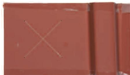
圖 18. 面板經過1000小時泡水試驗後
