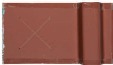
圖 16. 面板經過1000小時快速循環腐蝕試驗後
